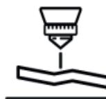
Cabezal automático para trabajo en superficies irregulares, no importa si la plancha está pandeada, el cabezal mantendrá una distancia constante durante todo el corte.
